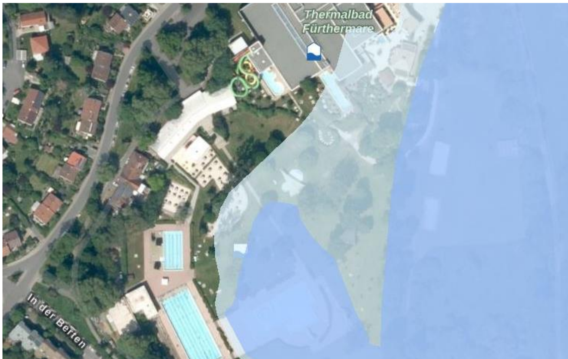
Abbildung 14: Darstellung des HQ100 (dunkelblau) und des HQExtrem (hellblau) im Umfeld des Plangebietes (Quelle: TB Markert und Bayerische Vermessungsverwaltung, 2024)
